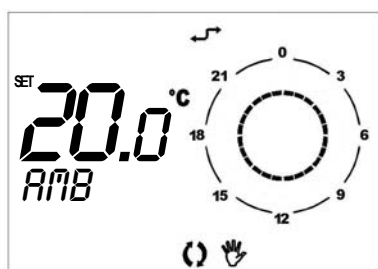
Figura 9 – Funz. automatico forzato.
